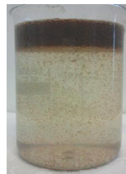
Rohwasser vor und nach Flotation
